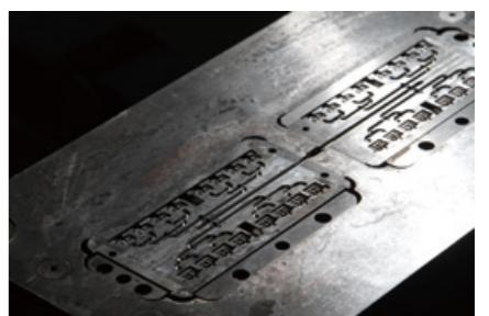
部品製造に欠かせない金型技術は創業時からのコア技術です。培われ蓄積されたノウハウと技術は、微細化が進むコネクタにおけるサブミクロン単位(狭ピッチ)の精密金型製造というカタチで現代に息づいており、設計から加工(切削・研削・放電)、量産まで、一貫した生産体制で、ユーザー企業の様々なニーズに応えています。中でも金型の量産化は、品質の均一化、連続生産への耐久性、メンテナンス性が求められるために高い技術が必要とされ、タツモはその点において優位性を誇っています。
